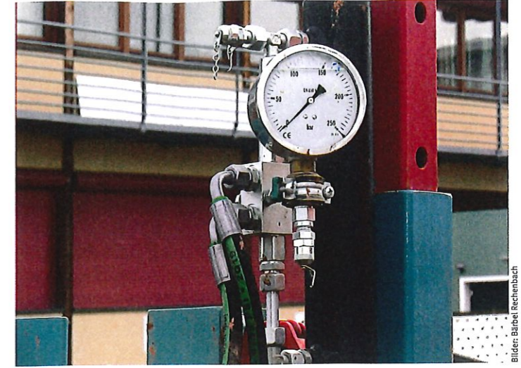
Ein Manometer misst alle relevanten Daten des Auftriebs und der Rückverfestigung exakt.
